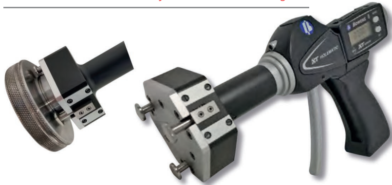
Digital-Schnellmessgeräte für Außennutenmessung von \varnothing 20-300mm/Messweg 5mm
